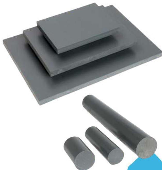
El PVC expandido/espumado es un tipo específico de material plástico, mucha gente lo conoce como Komatex, sin embargo esta es una marca comercial. Estos paneles están compuestos de una capa central de espuma de PVC rodeada por dos capas de PVC sólido, esta estructura proporciona una combinación única de ligereza y resistencia, es conocido por su superficie lisa y su capacidad para ser cortado y manipulado fácilmente lo que lo hace adecuado para una variedad de aplicaciones.
